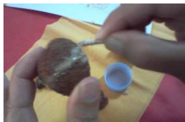
Renforcer et recoller la coque avec une résine epoxy
