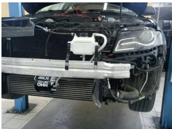
Sous le capot, réservoir d'eau et électrolyseur !
