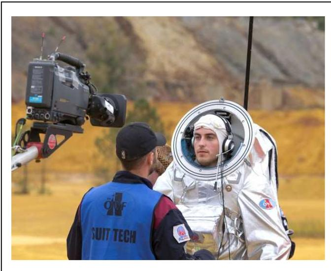
Le Testeur Ulrich Luger est entouré par toute une équipe qui l'aide à s'habiller, avec des sous-vêtements spéciaux, un casque de pilote, des accessoires pas toujours confortables pour les bras et les jambes, et quantité de capteurs et de câbles.
