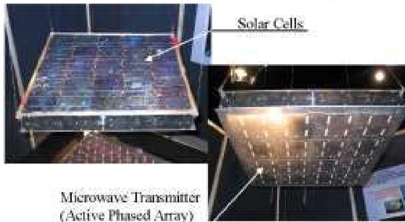
L'illustration ci-dessus montre le panneau en sandwich avec les cellules solaires au-dessus et les projecteurs micro-ondes de l'autre côté.
