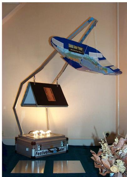
Pour faciliter la compréhension du concept de Centrales Spatiales Orbitales et pour présenter de A à Z les technologies utilisées pour le Transport d'Énergie Sans Fil, le CNES et l'agence japonaise ISAS ont développé un démonstrateur fonctionnel portable.
